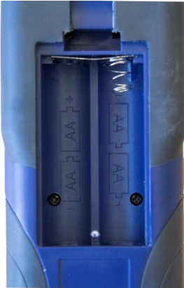
Abb. 4: Geöffnetes Batteriefach auf der Geräterückseite
