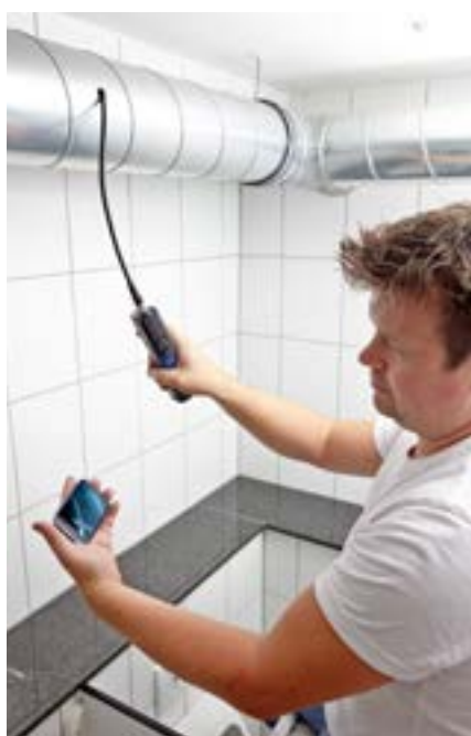
Video-inspectie met de Wöhler VE 200 video-endoscoop
