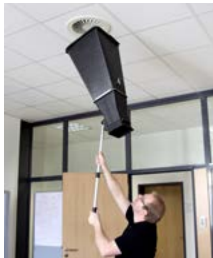
Luchthoeveelheid bij inblaas dankzij het praktische opzetstuk
