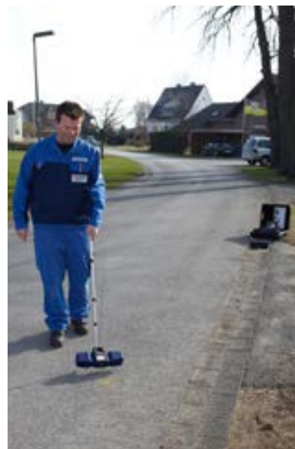
Met de Wöhler L 200 locator is de camerakop snel gelocaliseerd
