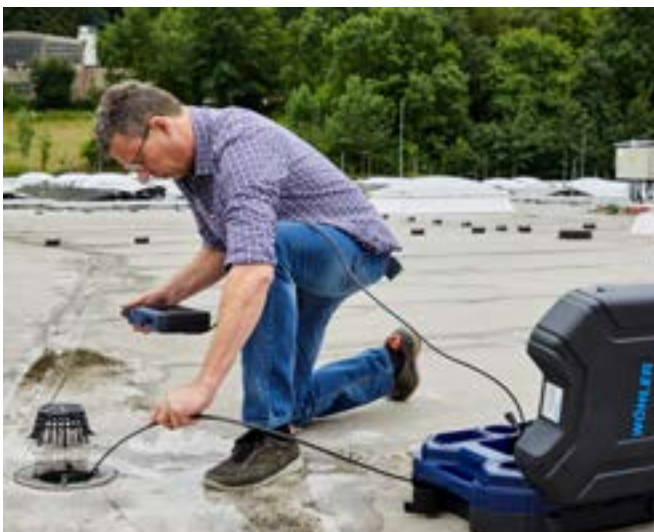
Betrouwbare rioolinspectie dankzij de waterdichte camerakop
