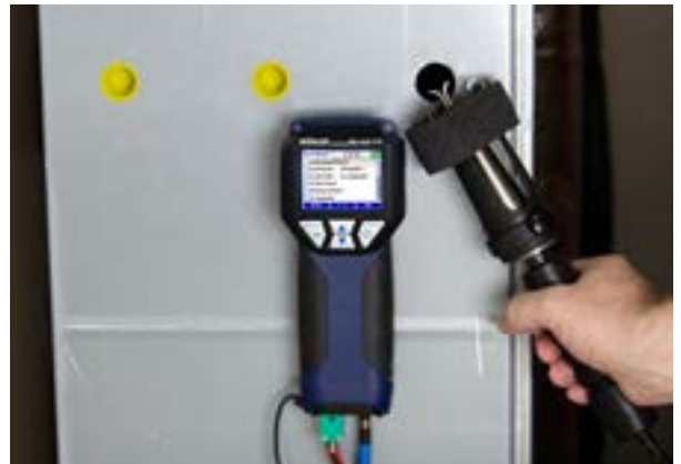
Praktische invulling van een traverse meting in leidingwerk
