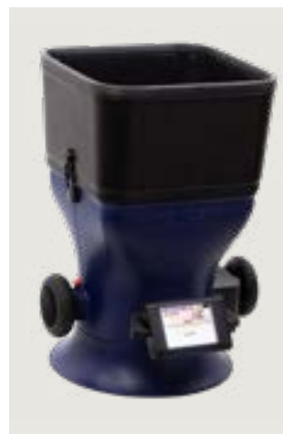
Wöhler CFM 600 nuldrukcompensatiemeter met opzettrecther voor inblaasroosters
