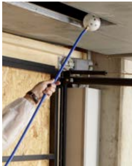
De Wöhler DH 420 persluchthaspel heeft een werklengte van 10 m
